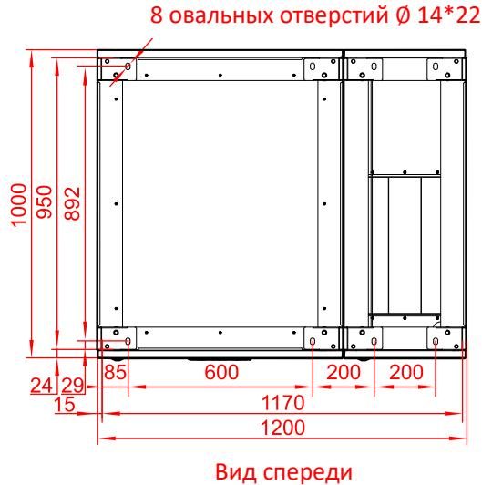
Рисунок 3-12. Рама ИБП с установочными отверстиями, АБ-МР33/400, АБ-МР33/500, АБ-МР33/600 с секцией нижнего подвода кабелей (ед. изм.: мм)
