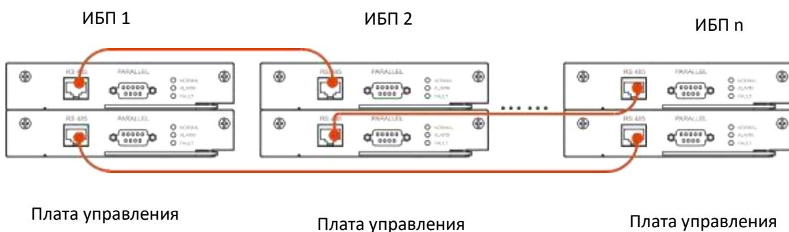
Рисунок 2-14. Соединение RS485 портов (несколько ИБП)
