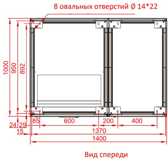
Рисунок 3-13. Рама ИБП с установочными отверстиями, АБ-МР33/800 (ед. изм.: мм)
