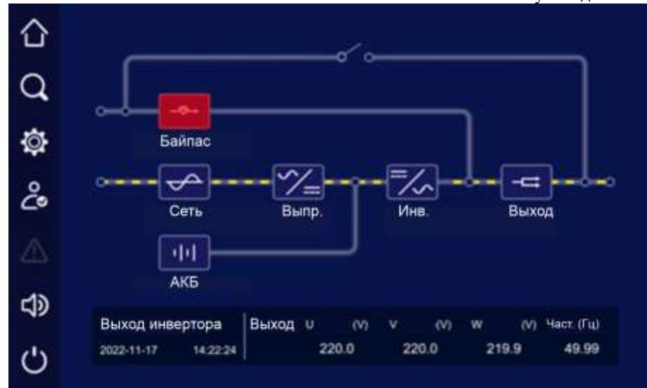
Рисунок 4-7. ИБП работает в режиме двойного преобразования
